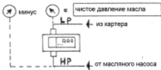
Это значение настройки реле контроля смазки должно быть 0,8 атм и оно уже выставлено на заводе. Встроенный таймер с задержкой, которая устанавливается от 45 до 60 секунд, позволяет повышать давление при пуске и исключает прерывания в работе в случае кратковременного падения давления. Рекомендуется установка РКС, имеющее кнопку ручного возврата.
