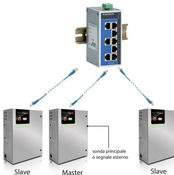
Такая группа сможет работать даже при выходе ведущего увлажнителя из строя (состояние тревоги, остановка производства,...), потому что его контроллер будет все равно передавать все необходимые данные на ведомые увлажнители. Естественно, если резервирование не включено, суммарная производительность группы увлажнителей в данном случае станет ниже.
