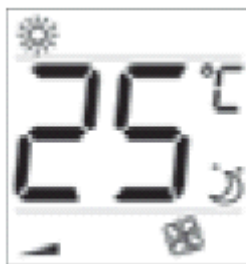
Рис. 2.m.h вид дисплея с активированным режимом ожидания (SLEEP)
