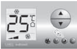
Рис. 2.м.1. Помещение пусто, нажмите любую клавишу чтобы установить присутствие
