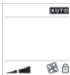
Рис. 2.m.i вид дисплея с активированной удаленной блокировкой
