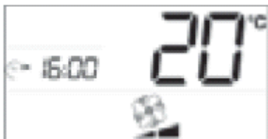
Рис. 2.h.d вид дисплея в состоянии «таймер включен»
