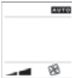
Рис. 2.m.f автоматический режим с активной функцией комфорта
